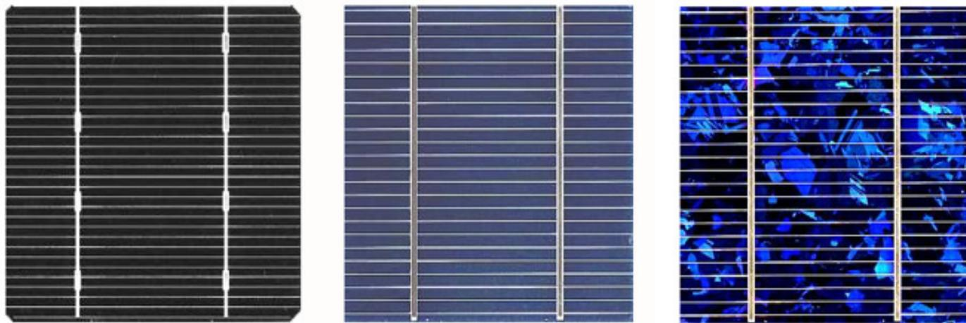
*Silizium-Solarzellen: monokristallin, schwarz (links) und blau (Mitte), und polykristallin, blau, Foto: solarnova.de*
